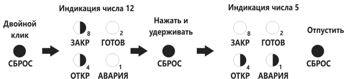
Рисунок 9 – Пример индикации тока 125%
